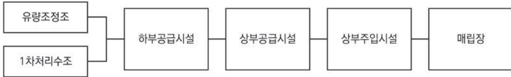
[그림 7.5] 침출수매립시설환원정화설비 계통도
