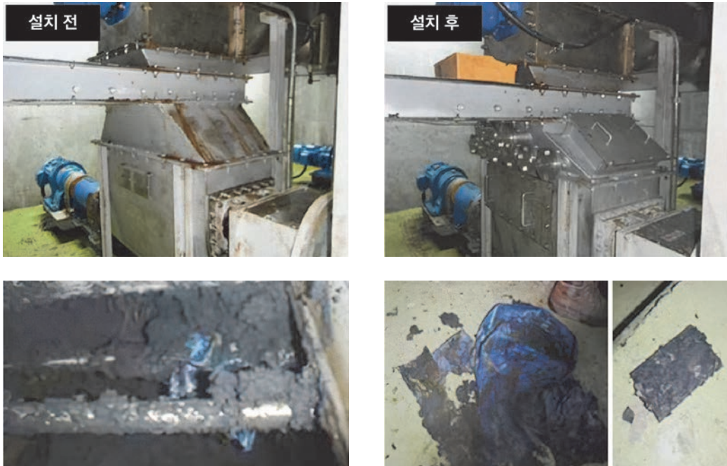
[그림 7.2] 봉타입 이물질 제거 장치설치 전후 비교 사진
