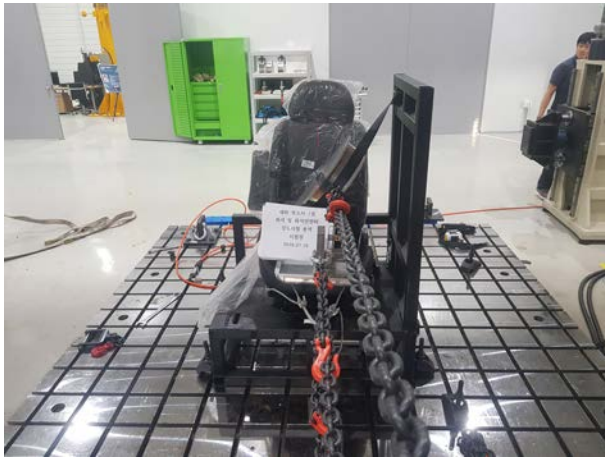
〈그림11〉1열 강도시험 시험 전
