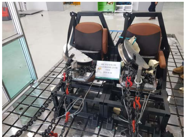
〈그림 19〉 2열 좌석 강도시험 시험 후
