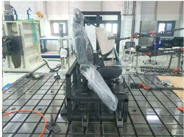
〈그림 17〉1열 강도시험 시험 후
