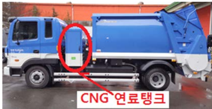
(한국형 전방저상 압축진개차의 CNG 연료탱크 설치 위치)
