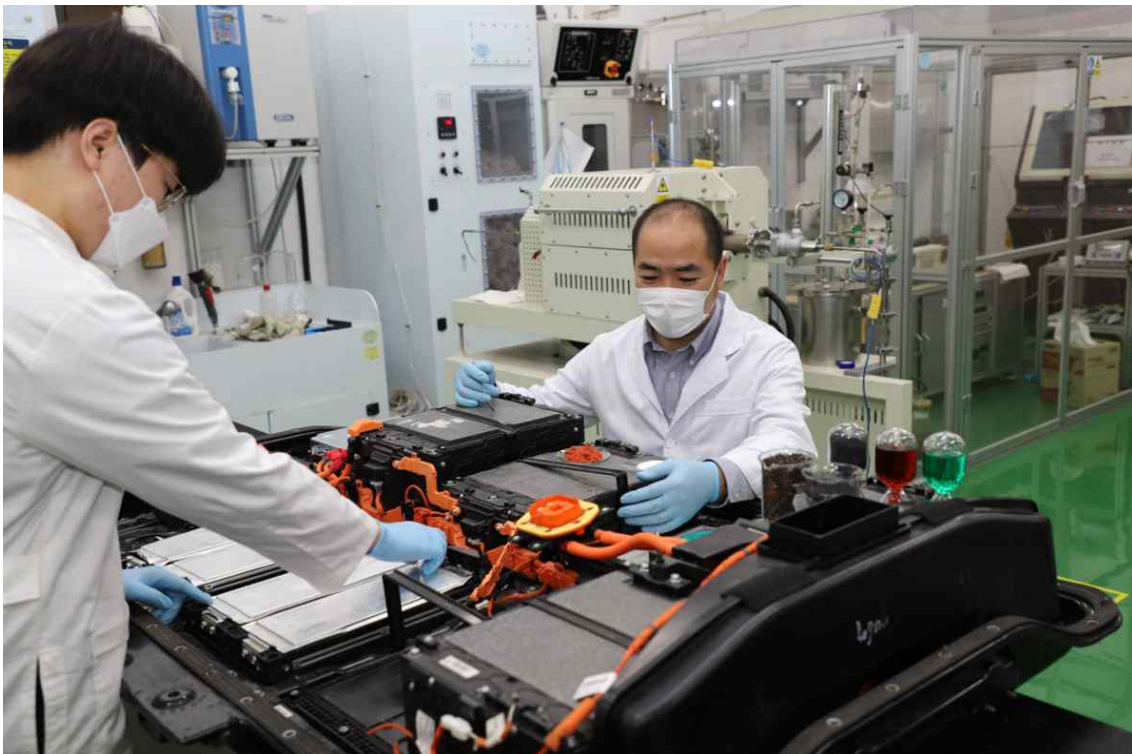
[사진설명] 김흥인 센터장(우측)이 전기차 폐배터리에서 폐배터리셀을 분리하는 공정을 수행하고 있다.
